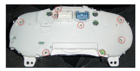
Enferne die Platine aus der der Halterung. Die Platine ist an den beiden rot eingekreisten Orten befestigt. Mit ein bisschen kraft aufwand lässt sich die Platine leicht entfernen.
