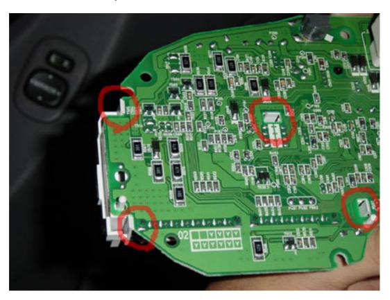
Die mit einem gelben Pfeilen gekennzeichneten LED's sind die Anzeige-LED's Gelbe Kreise die LCD LED
